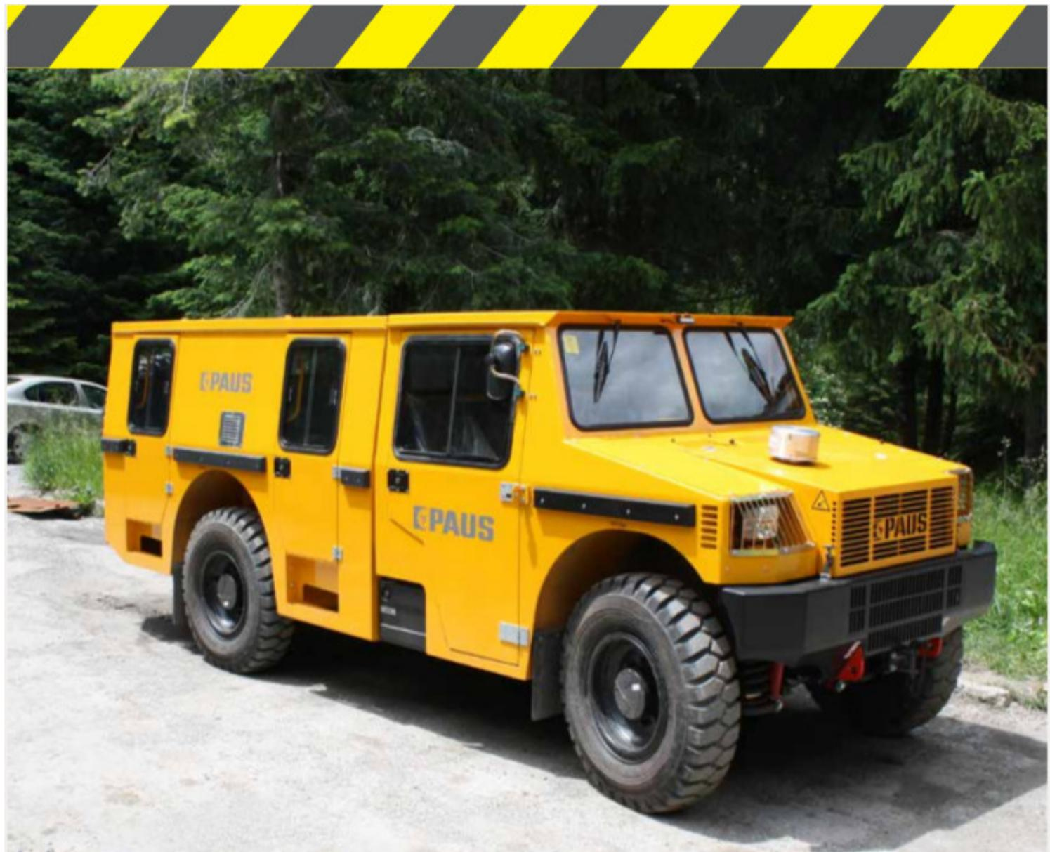
Сето тоа е поставено на крута шасија, а возилото е опремено и со електричен вител со 26 метри сајла, монтиран на предниот браник. За робусноста на конструкцијата најдобро кажнува тежината на возилото која изнесува 6.700 килограми. Носивоста му е два тона, а целиот пакет заокружен со безбедносен противпожарен систем кој се активира со притисок на копче и рачен апарат за гасење пожар.
